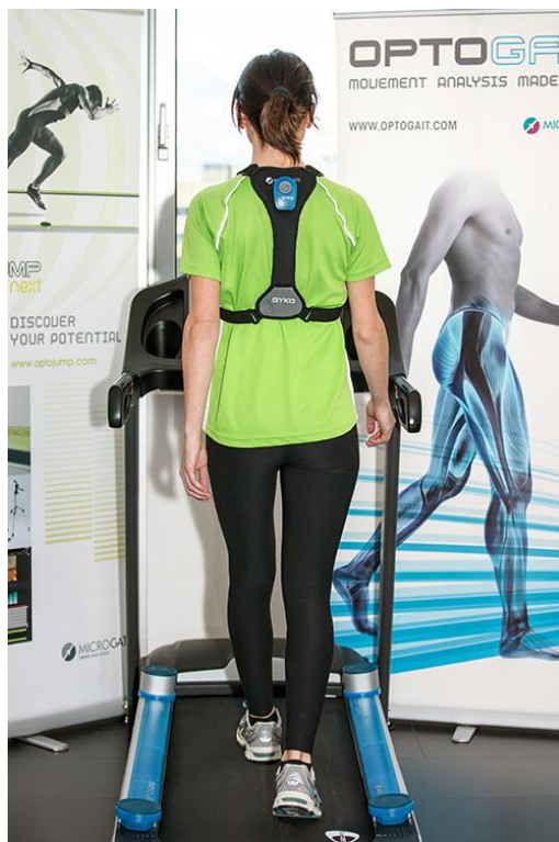
Slika 14. Prikaz kako se GYKO mjerni instrument postavlja na ispitanike (Preuzeto sa: https://training.microgate.it/en/products/gyko-0 )
